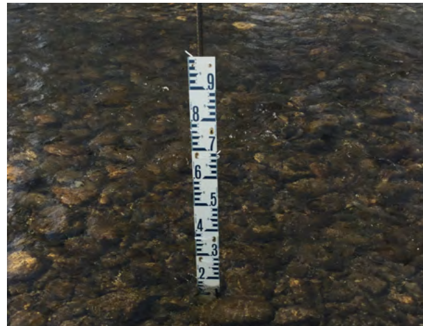
Figure 14. Mesure du débit à l'aide d'une échelle limnimétrique
